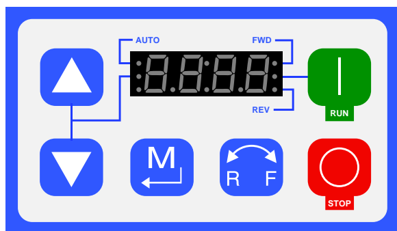
Figure 15 Pannello di controllo VFD
