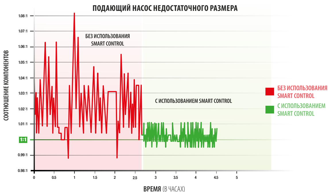
Рис 9. Данные график показывает преимущества использования режима Reactor Smart Control.
