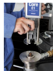
3. Faites glisser le moteur électrique pour le retirer
