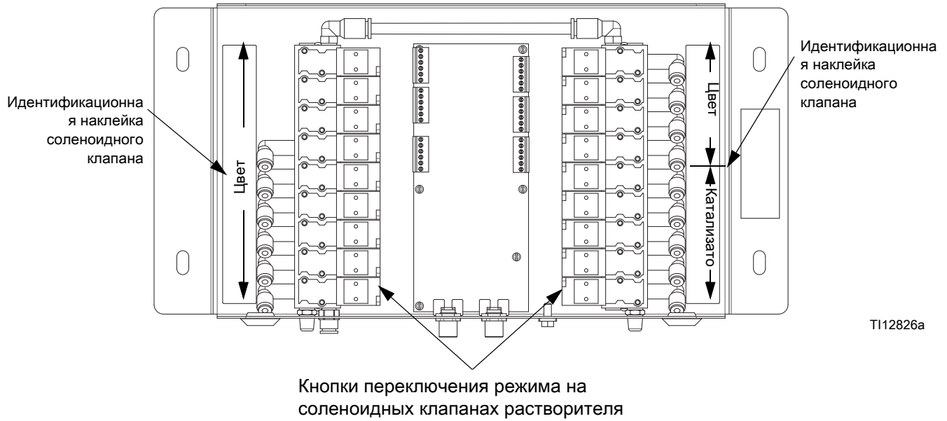
Рис. 3: Соленоидные клапаны смены цвета
