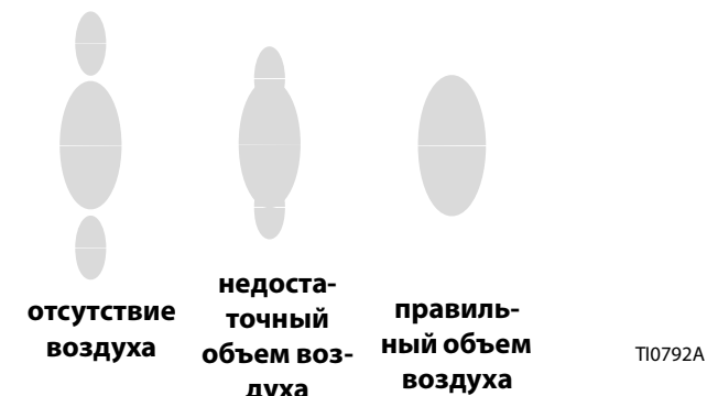
Рис. 6. Проблемы с формой окрасочного факела
