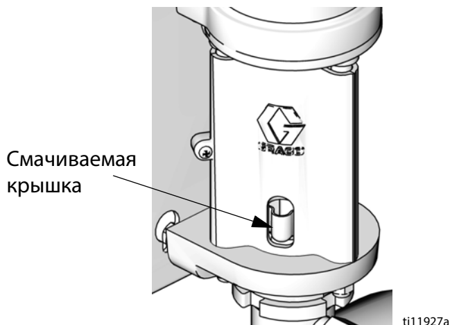
Рис. 6. Наполнение смачиваемой крышки
