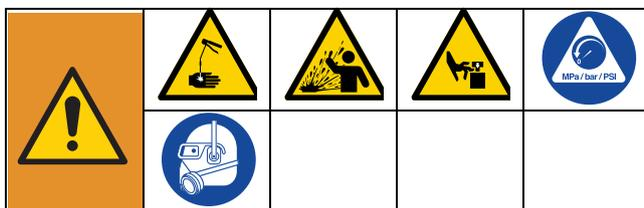
L'apparecchiatura rimane pressurizzata finché la pressione non viene scaricata manualmente. Per evitare gravi lesioni causate dal fluido pressurizzato, ad esempio iniezioni nella pelle, da schizzi di fluido e da parti mobili, seguire la Procedura di scarico della pressione quando si interrompe l'erogazione e prima di pulire, controllare o sottoporre a manutenzione l'apparecchiatura.
