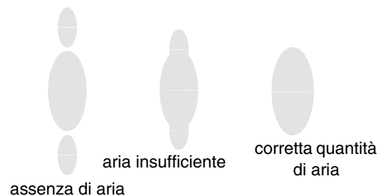
FIG. 8. Problemi di distribuzione della spruzzatura
