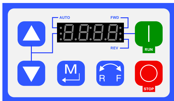
Figure 15 Panel sterowania napędu VFD
