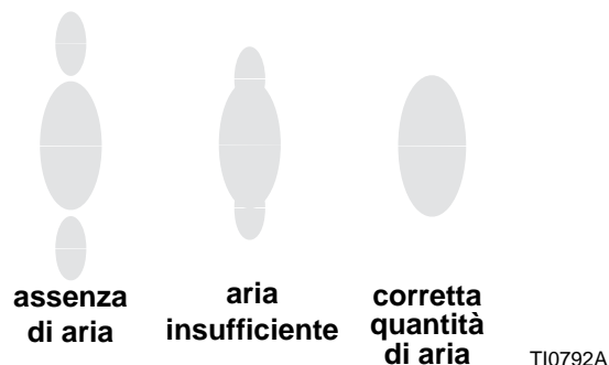
Fig. 5. Problemi di ventaglio di spruzzatura
