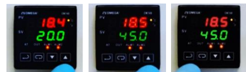
그림 3-8: ▲ ▼를 눌러 SV를 변경합니다. ↶ 키를 눌러 변경 내용을 저장합니다.
