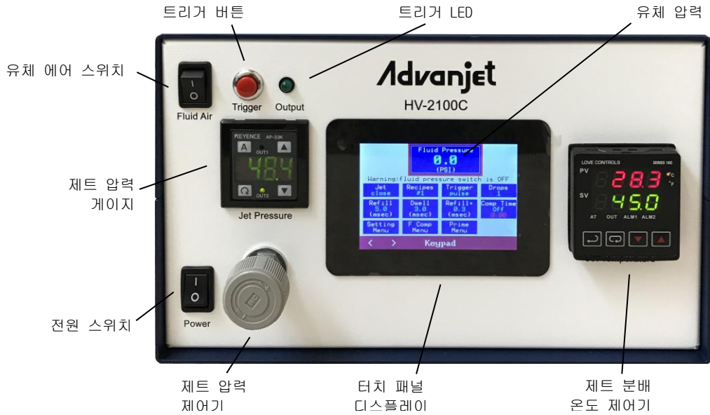
그림 3-1: HV-2100C 전면 패널 제어
