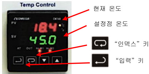
그림 3-6: 현재 값(PV), 설정 값(SV), 입력 키 및 인덱스 키
