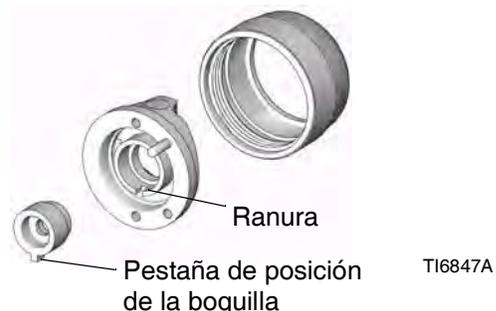
**Fig. 7: Configuración de la boquilla de pulverización y el cabezal de aire**
