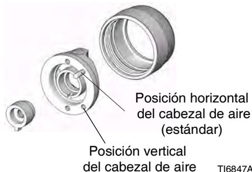
**FIG. 11: Posiciones de pasador de alineación del cabezal de aire**
