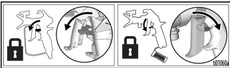
2. Завъртете превключвателя ON/OFF (Вкл./Изкл.) на позиция **OFF** (Изкл.).
