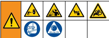
Για να αποτρέψετε σοβαρό τραυματισμό από το υγρό που βρίσκεται υπό πίεση, όπως έγχυση στο δέρμα, διασκορπισμός υγρού και τραυματισμό από κινούμενα εξαρτήματα, ακολουθείτε τη **Διαδικασία εκτόνωσης πίεσης** όταν διακόπτετε τον ψεκασμό και πριν από τον καθαρισμό, τον έλεγχο ή τη συντήρηση του εξοπλισμού.
