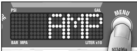
**ΣΗΜΕΙΩΣΗ:** Εμφανίζεται για λίγο η ένδειξη AMP SWITCH και έπειτα ακολουθεί η ρύθμιση του διακόπτη ενισχυτή.
