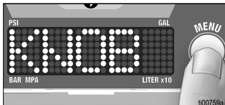
3. Ρυθμίστε το ποτενσιόμετρο στη θέση μέγιστου ψεκασμού, λίγο πριν το TurboClean.
