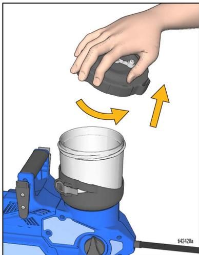
3. Verifique que el filtro de la bomba esté puesto en el fondo de la copa, en la entrada de la bomba. Con las pinturas, use el filtro de malla de color negro y, con los tintes y materiales poco espesos, use el filtro de azul.
