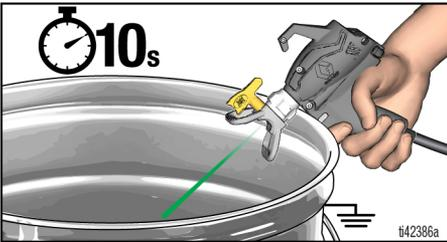
8. Gire la boquilla hasta la posición de pulverización.
