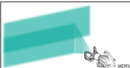
Si aparecen colas al pulverizar a máxima presión de pulverización:
