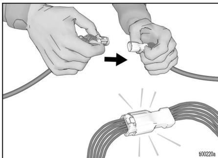
16. Antes de colocar la cubierta de la carcasa, asegúrese de que los cables están colocados de forma segura en sus canales, lejos de puntos de aplastamiento, como las partes que sobresalen de los tornillos y las costuras de la carcasa.
