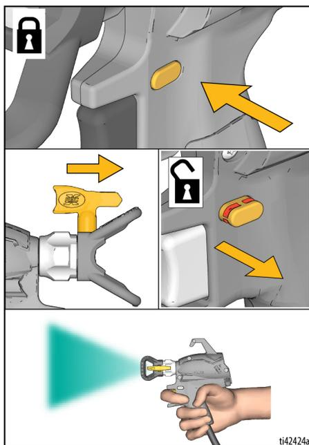
**NOTA:** Si la boquilla sigue obstruida, repita los pasos 1 y 2 con el control de caudal puesto a 10. Si sigue atascada, es posible que tenga que sustituir la boquilla.
