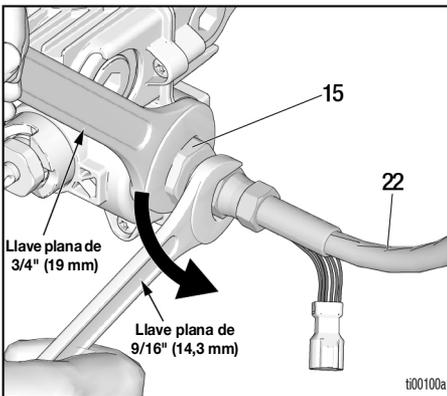
9. Retire los dos tapones (3b) de las válvulas de salida con una llave Allen de 8 mm (5/16"). Retire el adaptador de manguera (15) con una llave plana de 19 mm (3/4"). Retire las tres válvulas de salida (3a).
