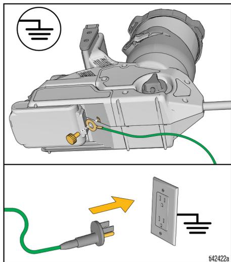
El pulverizador está equipado con un enchufe y cable de tierra. El enchufe debe conectarse a una toma eléctrica con buena conexión a tierra cuando se vayan a pulverizar o a limpiar materiales inflamables o con base de aceite, consulte **Información importante sobre la conexión a tierra**, página 4. Cuando conecte el enchufe y el cable de tierra, aleje el pulverizador de la zona de pulverización.
