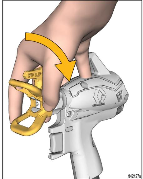
**NOTA:** La pistola de pulverización lleva integrada al final una junta para disolvente (color amarillo). Esto permite usar el OneSeal™ estándar (B) para todas las aplicaciones de material.
