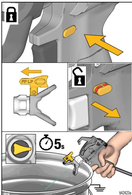
2. Ponga el seguro del gatillo. Gire la boquilla hasta la posición de pulverización. Quite el seguro del gatillo y siga pulverizando.
