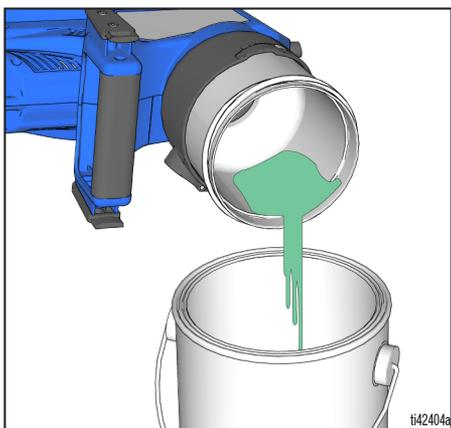
**NOTA:** Limpie siempre el pulverizador con un filtro limpio puesto para evitar que se acumulen residuos en la bomba o en la pistola de pulverización.
