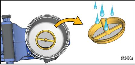
**NOTA:** Para una extracción más sencilla del filtro, tire del poste del filtro (1) hacia el reborde (2) del filtro.
