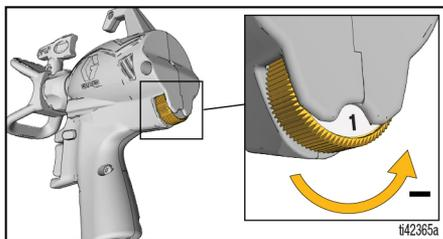
El control de control de caudal permite ajustes de presión precisos. Para evitar la sobrepulverización, empiece siempre con la velocidad más baja y vaya incrementando la velocidad poco a poco hasta que obtenga un patrón de pulverización aceptable.
