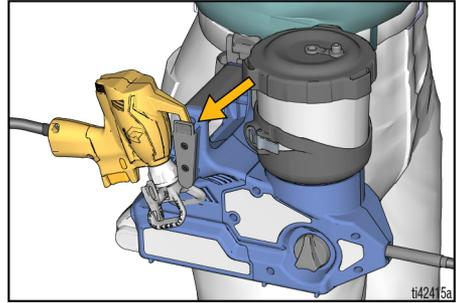
5. Para retirar el pulverizador del cinturón, presione el clip de liberación de la pistolera y tire hacia arriba del pulverizador.
