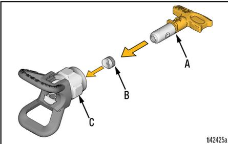
4. Inserte la boquilla de pulverización en el portaboquillas.
