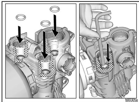
13. Ponga dos tapones de las válvulas de salida (3b) y el adaptador de manguera (15). Use una llave Allen de 8 mm (5/16") para poner los tapones de las válvulas de salida. Apriete el adaptador de la manguera a 6,8 N·m (60 lb-pulg.). Apriete los tapones de las válvulas de salida hasta que estén ajustados (2,3 N·m [20 lb-pulg.]).
