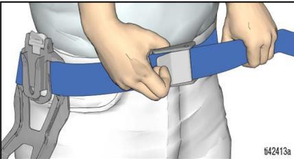
3. Acople el pulverizador a la pistolera del cinturón en la orientación que prefiera (manguera mirando hacia delante o hacia atrás).
