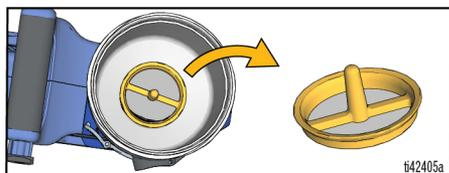
**NOTA:** Para una extracción más sencilla del filtro, tire del poste del filtro (1) hacia el reborde (2) del filtro.
