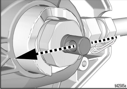
19. Installer le bouton d'amorçage (12) de manière à ce qu'il soit orienté vers l'avant. Installer la vis à tête cruciforme (21). Voir **Pièces de rechange**, page 38, pour les couples.
