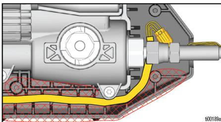
17. Installer le nouveau couvercle du boîtier (18). Fixer avec cinq vis à tête cruciforme (20). Voir **Pièces de rechange**, page 38, pour les couples.
