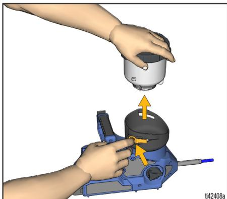
10. Nettoyer le réservoir, le couvercle du réservoir et le filtre de la pompe à l'eau chaude.
