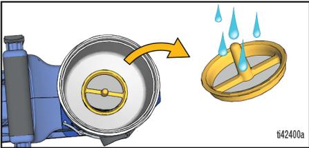
**REMARQUE :** Pour faciliter l'enlèvement du filtre, tirez la colonne du filtre (1) vers la rainure (2) du filtre.
