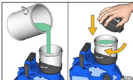
**REMARQUE :** L'utilisation du bouchon de stockage au-dessus du couvercle du réservoir est optionnelle. Le bouchon de stockage doit être ouvert pendant la pulvérisation afin d'éviter le verrouillage de l'air et le désamorçage.
