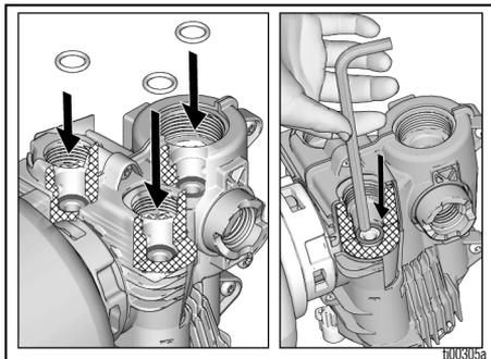
13. Installer les deux bouchons de la vanne de sortie (3b) et l'adaptateur de tuyau (15). Installer les bouchons de la vanne de sortie avec une clé Allen de 8 mm (5/16"). Serrer l'adaptateur de tuyau à 60 po-lb. Serrer les bouchons de la valve de sortie jusqu'à ce qu'ils soient bien serrés (20 po-lb).
