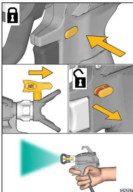
**REMARQUE :** Si la buse de pulvérisation est encore bouchée, répéter les étapes 1 et 2 avec la régulation de débit réglée sur 10. Si elle est encore bouchée, il faudra peut-être la remettre en place.
