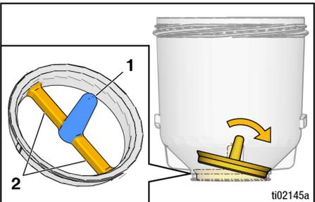
5. Réinstaller le filtre de la pompe au fond du réservoir.
