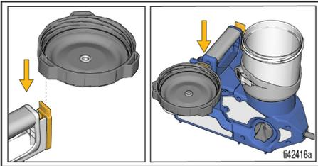
4. Retirer le filtre de pompe et nettoyer les débris de l'écran de filtre.
