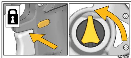
2. Si vous le souhaitez, retirer le pulvérisateur de la ceinture en appuyant sur le clip de desserrage de l'étui et tirer sur le pulvérisateur.
