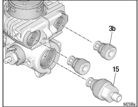
10. Nettoyer les trois vannes de sortie des débris. Vérifier que les billes se déplacent librement contre le ressort dans les dispositifs de retenue.
