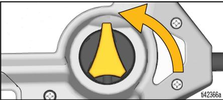
2. Appuyer fermement l'écrou du garde-buse métallique contre le seau métallique mis à la terre. Diriger le pistolet de pulvérisation dans le seau, déverrouiller la gâchette et actionner le pistolet de pulvérisation pour relâcher la pression.
