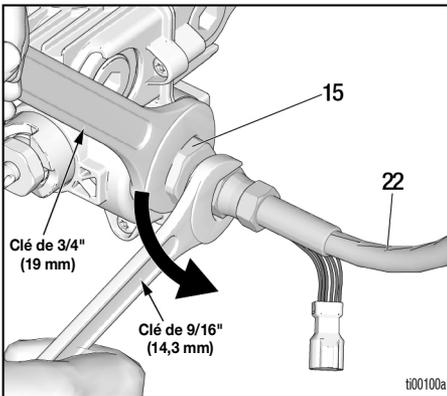
9. Retirer les deux bouchons de la vanne de sortie (3b) à l'aide d'une clé Allen de 8 mm (5/16"). Retirer l'adaptateur de tuyau (15) à l'aide d'une clé de 3/4". Retirer les trois vannes de sortie (3a).
