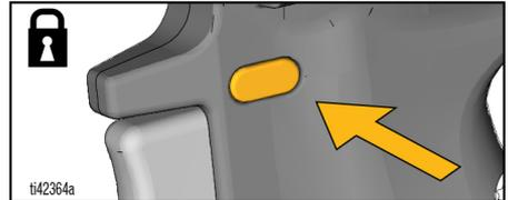
2. Tourner le bouton d'amorçage vers le haut en position PRIME pour décompresser le système.
