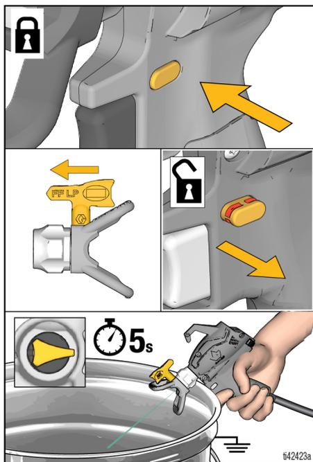
2. Verrouiller la gâchette. Tourner la buse de pulvérisation sur la position SPRAY. Déverrouiller la gâchette et continuer la pulvérisation.
