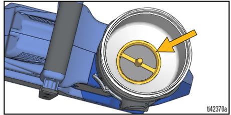
6. Remplir le réservoir de peinture et remplacer le couvercle du réservoir.
