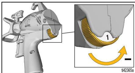
La régulation du débit permet un réglage de la pression précis. Pour réduire la pulvérisation excessive, toujours commencer par vaporiser à la vitesse minimale pour obtenir un jet de pulvérisation correct.
