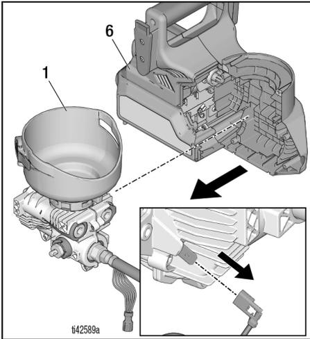
8. Débrancher les fils électriques. Retirer le tuyau (22) de l'adaptateur de tuyau (15) à l'aide de deux clés.
