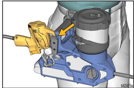
5. Pour retirer le pulvérisateur de la ceinture, appuyer sur le clip de desserrage de l'étui et tirer sur le pulvérisateur.
