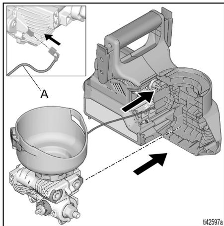
15. Raccorder les fils électriques.
