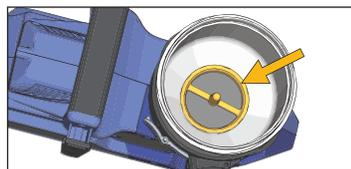
**6 Remplir le réservoir de peinture et replacer le couvercle du réservoir. Suivre les instructions de DÉMARRAGE pour continuer.**
