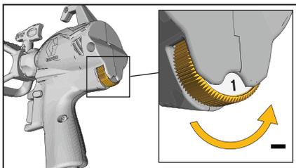
**2 Diriger le pistolet sur un morceau de carton usagé et appuyer sur la gâchette pour tester le jet de pulvérisation. Ajuster les éléments suivants pour obtenir le jet de pulvérisation voulu:**
