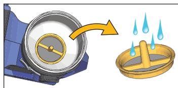
**5 Réinstaller le filtre de pompe au fond du réservoir.**
