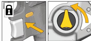
**2 Si besoin, retirer le pulvérisateur de la ceinture outil en appuyant sur le clip de desserrage de l'étui et en tirant sur le pulvérisateur.**
