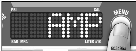
**NAPOMENA:** Nakratko će se prikazati oznaka **AMP SWITCH**, a zatim postavke prekidača pojačala.
