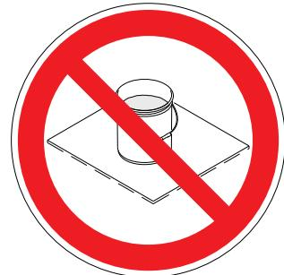
**Uvijek uzemljite metalnu posudu:** spojite vodič za uzemljivanje na metalnu posudu. Jedan kraj spojite na vedro, a drugi na uzemljivo, primjerice metalnu vodovodnu cijev.
