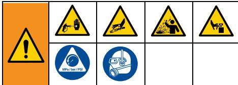
Ova oprema ostaje pod tlakom dok se tlak ručno ne otpusti. Kako biste izbjegli ozbiljne ozljede od tekućine pod tlakom kao što je ubrizgavanje u kožu, od prskanja tekućine i pokretnih dijelova, slijedite **Postupak otpuštanja tlaka** kada prestanete prskati i prije čišćenja, provjere ili servisiranja opreme.
