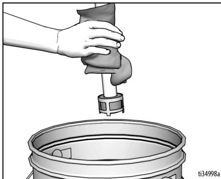
4. Stavite usisnu cijev u tekućinu za ispiranje. Za boju na bazi vode koristite vodu, a mineralni alkohol za uljanu boju. Postavite cijev za ispuštanje u posudu za otpad.
