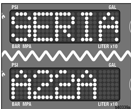
4. Kratko pritisnite gumb za prikaz i prikazuje se ukupan rad motora u satima.
