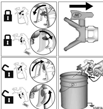
2. Aktivirajte blokadu otponca. Vratite mlaznicu raspršivača u izvorni položaj. Otpustite sigurnosnu blokadu otponca i nastavite prskati.
