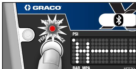
Postoje tri postavke osjetljivosti Watchdog: Niska, srednja i visoka. Za promjenu postavke osjetljivosti unesite pohranjene podatke na zaslon i idite na Watchdog. Pritisnite i zadržite tipku MENU za prebacivanje na Watchdog.
