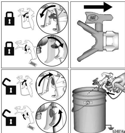
2. Aktivirajte zaklep sprožilca. Vmite pršilno konico v prvotni položaj. Deaktivirajte zaklep sprožilca in nadaljujte s pršenjem.
