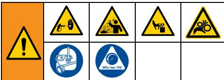
Za preprečitev resnejših telesnih poškodb zaradi tekočine pod tlakom, npr. injiciranja v kožo, razливanja tekočin in premikajočih se delov, sledite **Postopku za sproščanje tlaka**, čim zaključite s pršenjem in še pred čiščenjem, preverjanjem ali servisiranjem opreme.
