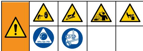
Oprema ostane pod tlakom, dokler tlaka ročno ne sprostite. Za preprečitev resnejše poškodbe zaradi tekočine pod tlakom, kot je injiciranje v kožo, razlivanja tekočin ali premikajočih se delov, sledite **postopku za sproščanje tlaka**, čim zaključite s pršenjem in še pred čiščenjem, preverjanjem ali servisiranjem opreme.
