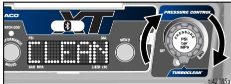
**OPOMBA:** TurboClean se uporablja samo za čistilne tekočine. Pršilnik v načinu TurboClean ne prši barve ali drugih materialov.
