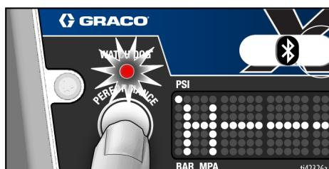
Obstajajo tri nastavitev občutljivosti zaščite Watchdog: Nizka, srednja in visoka. Če želite spremeniti nastavitev občutljivosti, vnesite shranjene podatke na zaslou in pojrite na Watchdog. Za preklop na Watchdog stisnite gumb za meni in ga zadržite.
