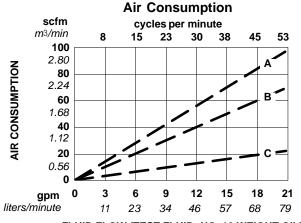
FLUID FLOW (TEST FLUID: NO. 10 WEIGHT OIL)
