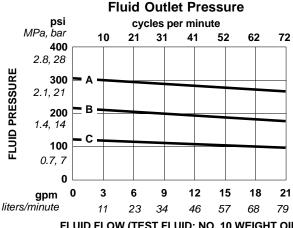
FLUID FLOW (TEST FLUID: NO. 10 WEIGHT OIL)
