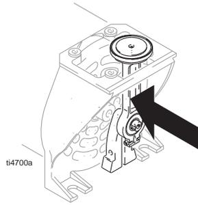
2. Replace and tighten piston bolt.
