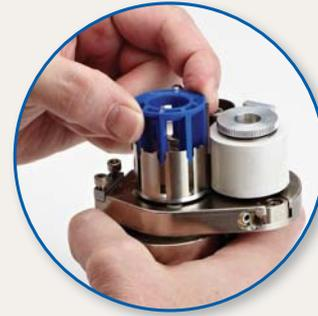
Sostituire con una nuova cartuccia della lama
