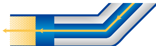
Trayecto del fluido FIFO (primero en entrar, primero en salir)
