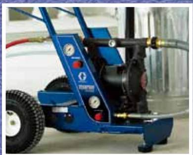
泵浦和喷枪供气系统的控制开关分离
