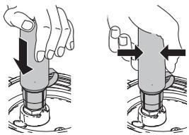
Inserire lo strumento Pump Armor nell'ingresso materiale e spingerlo con forza finché non si arresta. Premere il serbatoio finché Pump Armor non fuoriesce dal tubo di scarico.
