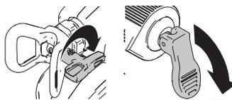
Girare l'ugello al contrario e mettere la valvola di adescamento/spruzzatura in posizione DOWN. Premere il grilletto dello spruzzatore in direzione di una zona di scarico finché non compare più vernice nell'acqua o nel fluido di lavaggio.
