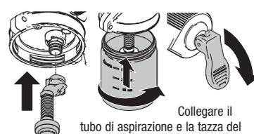
Collegare il tubo di aspirazione e la tazza del materiale. Spingere la valvola verso il basso in posizione di spruzzatura.
