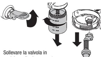
Sollevare la valvola in posizione di adescamento. Rimuovere la tazza del materiale e il tubo di aspirazione.
