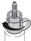
Rimuovere il tappo di sicurezza dal serbatoio Pump Armor e avvitare lo strumento sullo spruzzatore. **NOTA:** Per risultati ottimali, assicurarsi che il serbatoio sia pieno.
