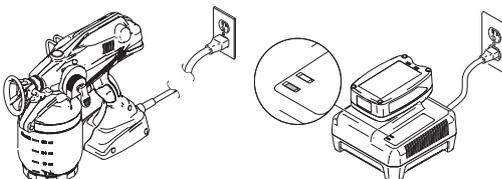
Collegare lo spruzzatore a una presa adeguatamente messa a terra, oppure caricare completamente una batteria e inserirla nello spruzzatore.
