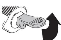
Con la valvola di adescamento/spruzzatura in posizione UP, premere il grilletto dello spruzzatore per 5-10 secondi
