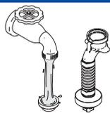
Rimuovere il tubo di aspirazione e utilizzare un cacciavite per togliere il filtro. Pulire con acqua (o fluido di lavaggio).
