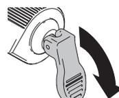
Rilasciare il grilletto e mettere la valvola di adescamento/spruzzatura in posizione DOWN per la spruzzatura. **A questo punto si è pronti a spruzzare.**
