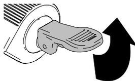
3. Luego suelte el gatillo y coloque la válvula de cebado/pulverización hacia ABAJO a la posición de pulverización. ¡Ahora está listo para pulverizar!
