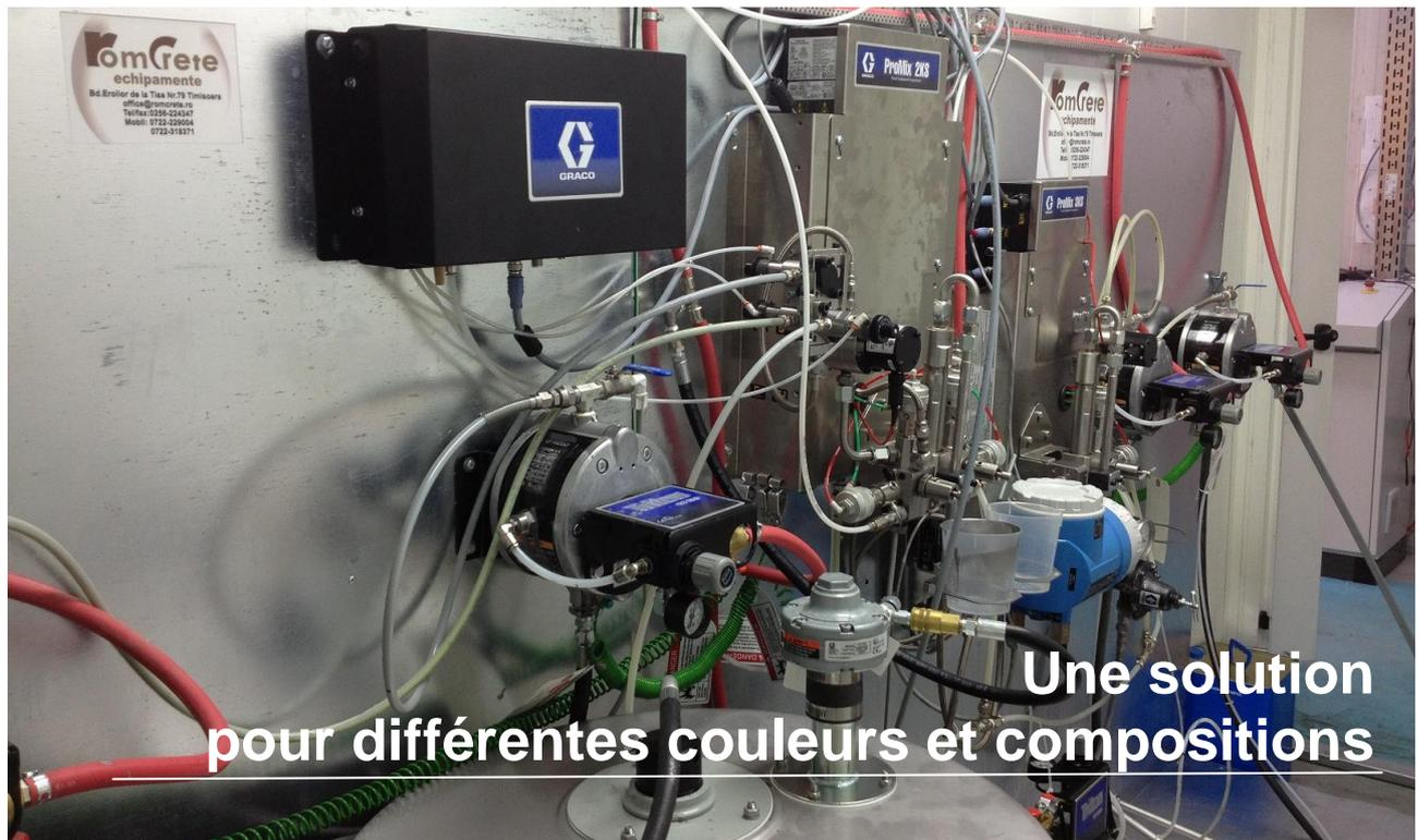
Arctic, une société roumaine fabriquant des congélateurs recherchait une solution lui permettant de peindre automatiquement plus de 27 types de pièces en appliquant 2 couleurs et compositions différentes. La peinture Akzo Nobel utilisée est une peinture de finition bi-composant, mais elle doit être diluée pour une application correcte sur une surface plastique avec un film de 25  $\mu\text{m}$ .
