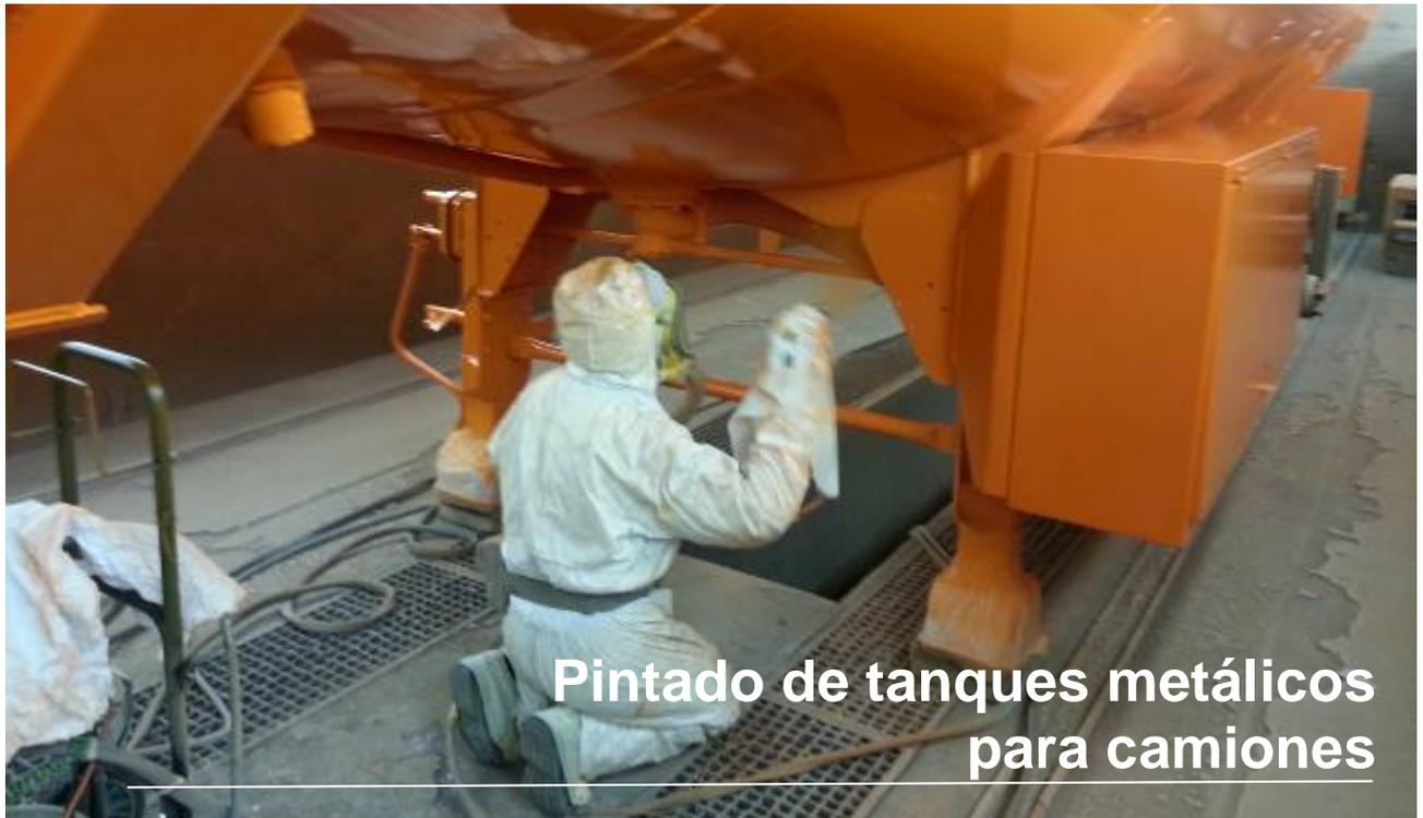
Cisternas Cobo es una empresa ubicada en el norte de España que fabrica distintos tipos de tanques metálicos para camiones. El proceso de pintado de estos grandes tanques metálicos se realiza en cabinas especiales hechas a medida. Para pintar los tanques se utilizan pistolas de pulverización aerográfica convencionales, sin embargo estas producen demasiada sobrepulverización y un alto consumo de pintura.
