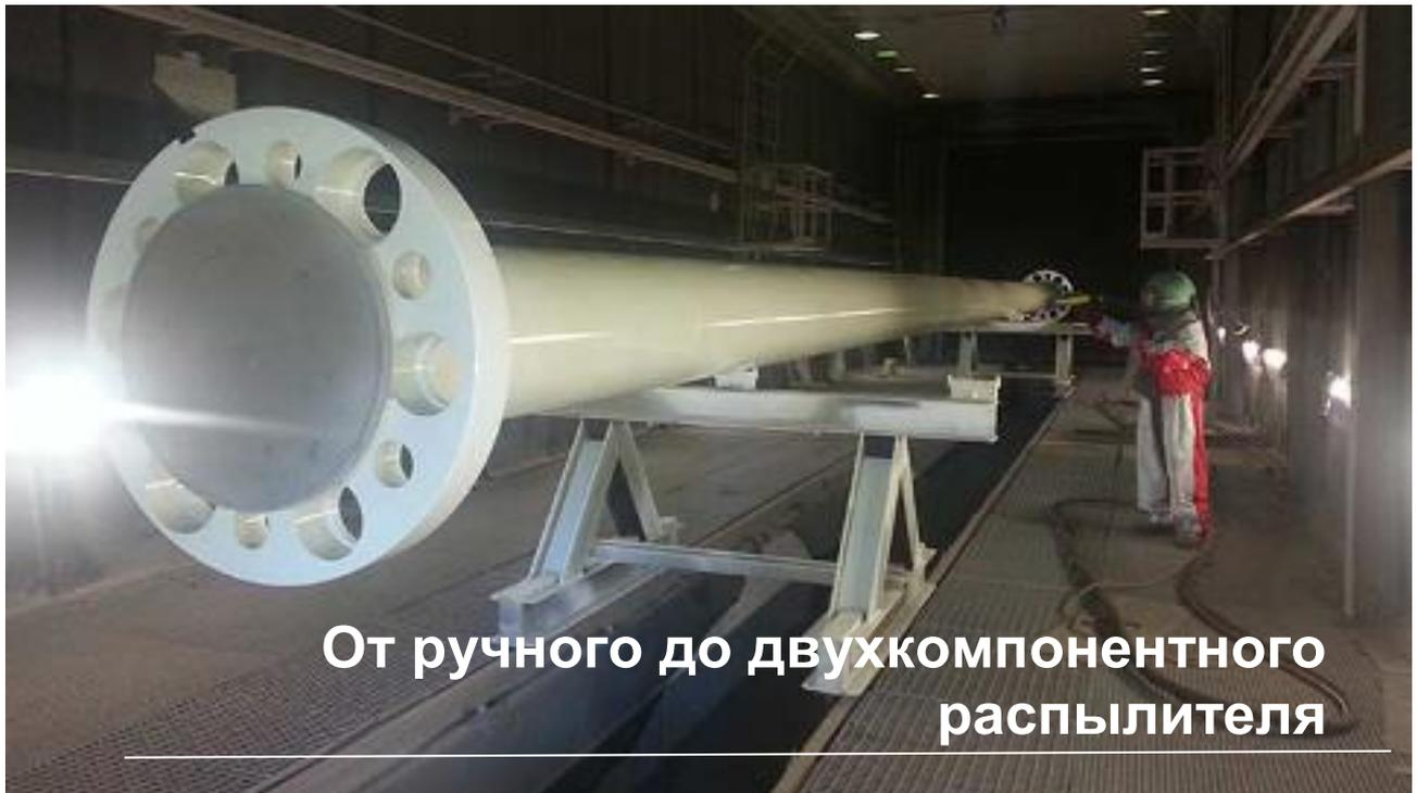
Компания Freeman France, субподрядчик Cameron, расположена на юге Франции, в городе Безиерс. Основной специализацией компании является нанесение защитных покрытий на поверхность труб большого диаметра, используемых для перекачивания нефтепродуктов. Автоматическая линия окраски расположена на территории компании Cameron. Сотрудники компании Freeman осуществляют окраску труб различных размеров. Раньше окраска труб производилась вручную.
