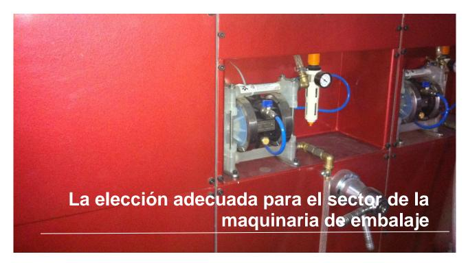
Seri Makina, de Estambul (Turquía), fabrica una serie de máquinas de embalaje en línea que imprimen y pliegan cajas corrugadas. Dependiendo del uso de distintos colores, en cada máquina se emplean entre una y cuatro bombas de doble diafragma. En el equipo que contenga la encoladora se necesita una bomba más de doble diafragma.
