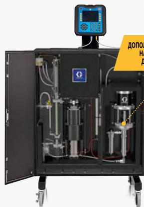
ДОПОЛНИТЕЛЬНЫЙ ВСТРОЕННЫЙ НАСОС ДЛЯ ПОВЫШЕНИЯ ДАВЛЕНИЯ МАТЕРИАЛА
