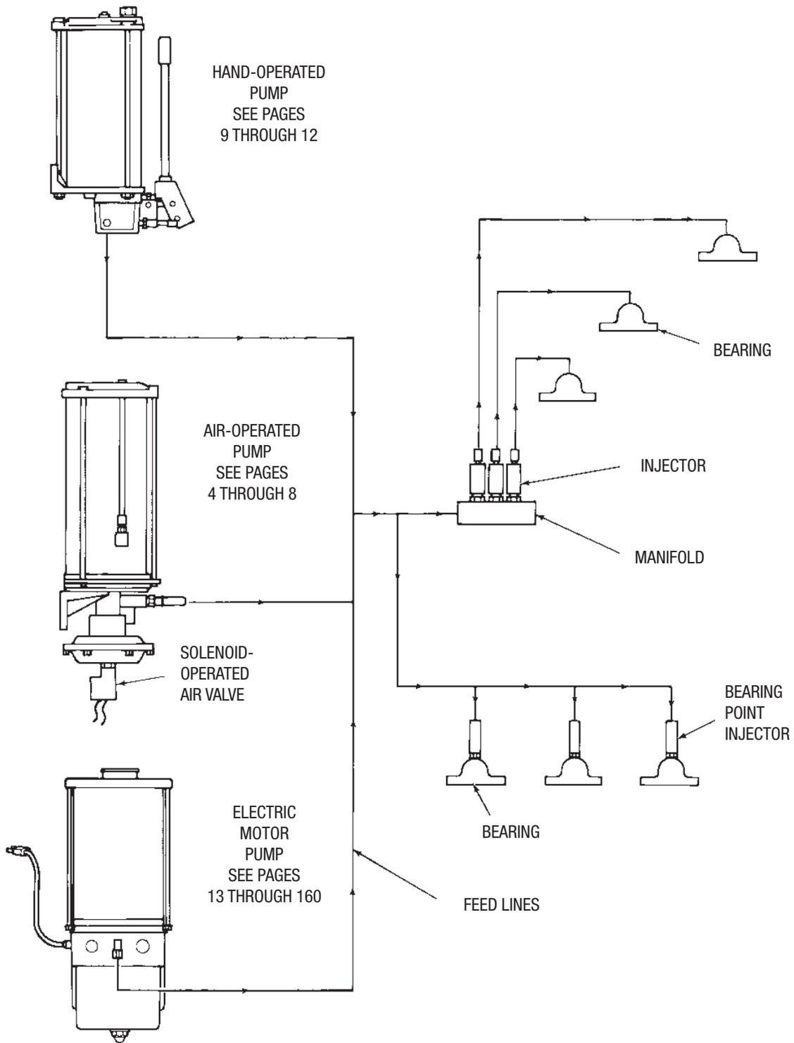
Figure 1. LubriSystem Diagram
