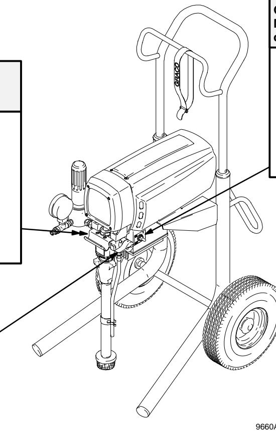
On/Off Switch / Interrupteur Marche/Arrêt / Interruptor de ligar e desligar / Interruptor On/Off
