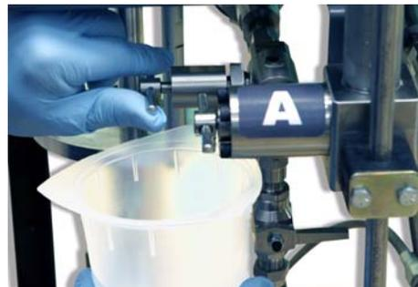
3. Fermer la vanne d'échantillonnage  $H^A$ .
