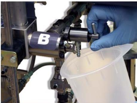
5. Fermer la vanne d'échantillonnage H<sup>B</sup>.
