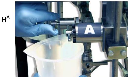
6. Actionner le pistolet en le tenant dans un seau mis à la terre. Laisser s'écouler env. 1 pinte (500 cc) de produit, puis appuyer sur
