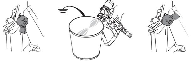
9. Fermer les vannes de purge de solvant J<sup>A</sup> et J<sup>B</sup>.
