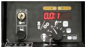
8. Dès que le côté B sera amorcé, appuyer sur
