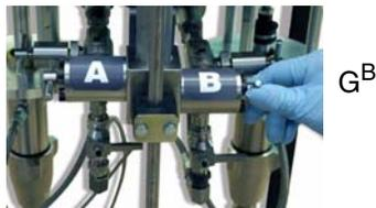
4. Mettre un récipient sous chaque vanne d'échantillonnage. Ouvrir doucement la vanne d'échantillonnage H<sup>A</sup>.
