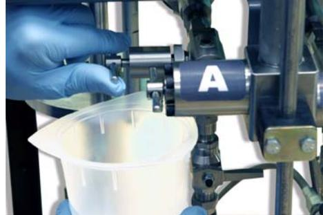
3. Fermer la vanne d'échantillonnage  $H^A$ .
