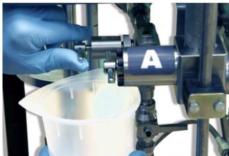
5. Placer un récipient propre de 1 quart (1000 cc) sous la vanne d'échantillonnage H<sup>B</sup>. Ouvrir la vanne d'échantillonnage H<sup>B</sup>. Une quantité de 500 cc s'écoulera, puis le débitmètre s'arrêtera. Fermer la vanne d'échantillonnage H<sup>B</sup>.
