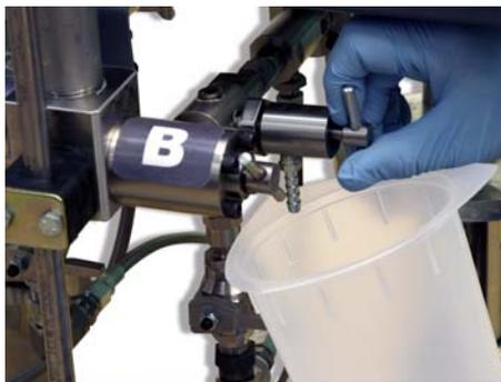
6. Une fois la distribution de composant B terminée, le volume de composant A s'affichera. Comparer le volume affiché avec le volume réel contenu dans le récipient A.
