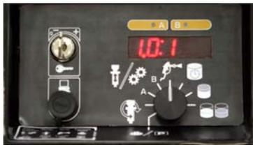
3. Actionner le pistolet en le tenant dans un seau et augmenter lentement la pression du régulateur d'air jusqu'à ce que la pompe se mette en marche et que le produit qui s'écoule soit propre sans interruption.
