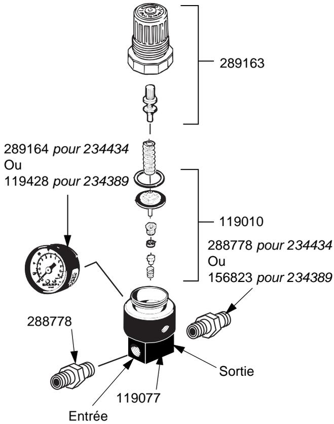
**NOTA:** 234389 est livré avec une soupape de décharge de pression.
