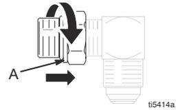
4. Desenrosque el racor hasta que esté correctamente orientado.
