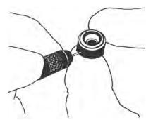
Fig. 23 Clean Module Parts
