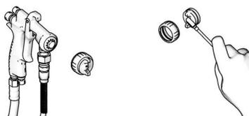
3. 使用适合的溶剂，清洗吸入管和入口过滤器。
