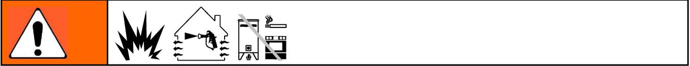
必须将设备接地。通过接地，可给电流提供静电聚集时或发生短路时逃逸的通路，减少出现静电和电击的危险。
