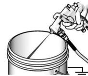
8. 从溶剂中拿开吸入管。继续喷射，直到所有溶剂流出喷枪。
