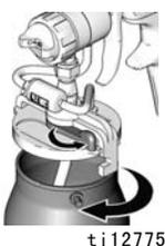
2. 向虹吸杯中倒入少量涂料制造商推荐的溶剂或水。
