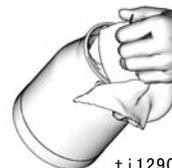
8. 卸下护环、空气帽和流体喷嘴。在溶剂或水中清洗。用一块被溶剂或水浸湿的抹布清洁喷枪正面。
