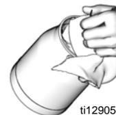
8. Rimuovere l'anello di tenuta, il cappello di polverizzazione e l'ugello del fluido. Pulire con solvente o acqua. Pulire la superficie della pistola con un panno inumidito in acqua o solvente.
