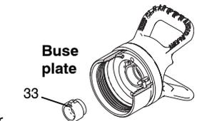
Remplacer le siège (33a) ou resserrer l'écrou de la protection si une fuite est constatée à l'avant du pistolet.
