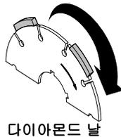
270 및 390 모델은 "전진 절단" 그라인딩을 위해 설계되어 있습니다 (드럼이 이동과 동일한 방향으로 회전). 480 및 630 모델은 "후진 (상부 절단)" 그라인딩을 위해 설계되어 있습니다 (드럼이 이동과 반대 방향으로 회전).
