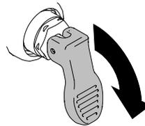
4. Mettre la buse de pulvérisation vers l'arrière en position UNCLOG (déboucher) et pulvériser dans une poubelle.
