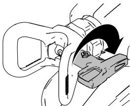
3. Richten Sie das Spritzgerät auf einen Abfallbereich, entriegeln Sie die Abzugssperre und bringen Sie das Entlüftungs-/Entlastungsventil nach unten in die Spritzposition (DOWN). Betätigen Sie den Abzug, um die Verstopfung zu lösen.
