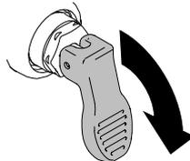
4. Drehen Sie die Düse in die Entstopfungsposition (UNCLOG) um und ziehen Sie das Spritzgerät in einen Abfallbereich hinein ab.
