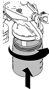
6. Premere il grilletto per 10 secondi, rilasciarlo e mettere la valvola di adescamento / decompressione GIÙ sulla posizione di spruzzatura.
