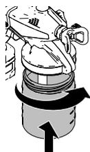
2. Collocare la valvola di adescamento / scarico in SU, poi premere il grilletto per 10 secondi.
