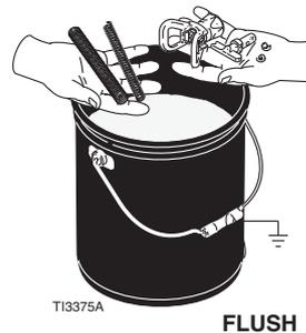
5. Coloque o tubo de sucção dentro de um balde metálico com ligação à terra, parcialmente cheio com líquido de lavagem. Prenda o cabo de terra à terra. Efetue os passos de Colocação em Serviço 1 - 6 (consulte a página 10) para remover a tinta do pulverizador. Utilize água para eliminar tintas à base de água e aguarrás para tintas à base de óleo.
