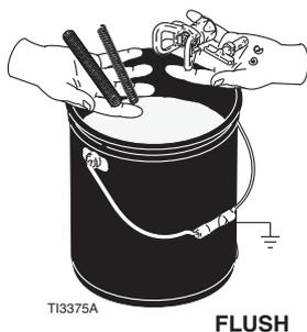
5. Saugschlauch in einen geerdeten Metalleimer geben, der teilweise mit Spülflüssigkeit gefüllt ist. Erdungskabel an einen Erdungsanschluss anbringen. Die Schritte 1-6 der Inbetriebnahme (siehe Seite 10) durchführen, um Farbe aus dem Spritzgerät zu spülen. Wasser für das Ausspülen von Farben auf Wasserbasis verwenden und Waschbenzin (auch Testbenzin genannt) für das Ausspülen von Farben auf Ölbasis.
