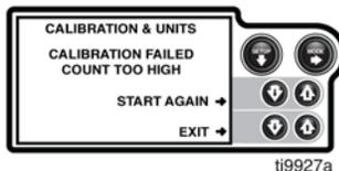
按動噴槍扳機控制按鈕以結束校準時，如果劃線機滾動小於校準長度，則顯示此消息。
