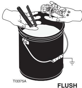
5. 將吸料管放入注有部份沖洗液體的接地金屬桶中。將接地電線連接到真正的接地點。執行啟動步驟 1 - 6（參閱第 10 頁）沖洗噴塗器中的塗料。用水沖洗水基塗料和礦物質以沖出油基塗料和已有油。
