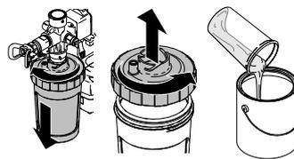
4. Umetnite novi uložak u spremnik i napunite trećinu uložka odgovarajućom tekućinom za ispiranje. Namjestite poklopac i priključite spremnik na raspršivač. Tresete raspršivač kako bi se očistio.
