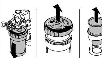
12. Sklop mlaznice/štitnika za raspršivanje očistite čistom tekućinom za ispiranje. Po potrebi se poslužite mekom četkom. Uklonite filter za materijal.
