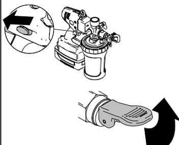
11. Uklonite i propisno zbrinite uložak za materijal i poklopac. Propisno zbrinite iskorištenu tekućinu.
