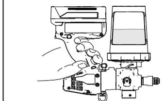
9. Postavite ventil za punjenje/otpuštanje pritiska DOLJE u položaj za raspršivanje. Ostatak tekućine raspršite kroz prednji dio raspršivača. Ponovite korake 8 – 9 ako raspršivač nije potpuno čist.
