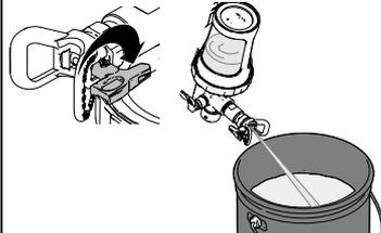
7. Uključite blokadu otkopca. Postavite ventil za punjenje/otpuštanje pritiska u položaj GORE. Odvijte mlaznicu/štitnik s raspršivača i namočite u tekućini za ispiranje. Uklonite spremnik i pravilno zbrinite tekućinu.
