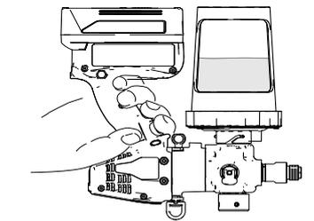
6. Okrenite mlaznicu raspršivača u položaj za ODČEPLJIVANJE. Ventil za punjenje/otpuštanje pritiska postavite DOLJE u položaj za raspršivanje, naopako okrenite raspršivač i 2 sekunde pritisćite otkopac.
