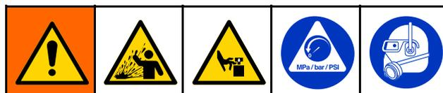
Это оборудование остается под давлением до тех пор, пока давление не будет сброшено вручную. Во избежание получения серьезной травмы в результате разбрызгивания жидкости и контакта с движущимися деталями выполняйте процедуру сброса давления после завершения распыления и перед чисткой, проверкой либо обслуживанием оборудования.
