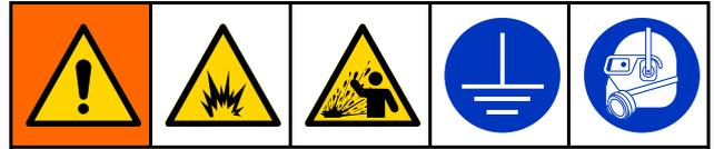
Во избежание пожара и взрыва всегда заземляйте оборудование и контейнер для отходов. Во избежание электростатического искрения и получения травм из-за разбрызгивания всегда проводите промывку при наименьшем возможном давлении.
