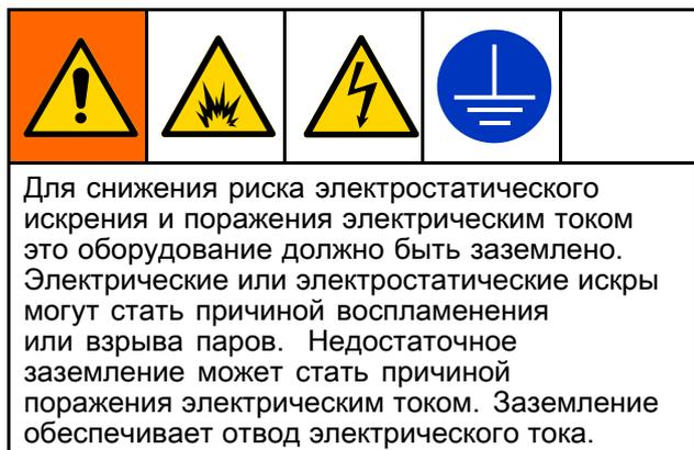
1. **Насос:** См. рис. 4 Ослабьте винт заземления и присоедините провод заземления. Надежно затяните винт заземления. Соедините другой конец провода с точкой истинного заземления.
